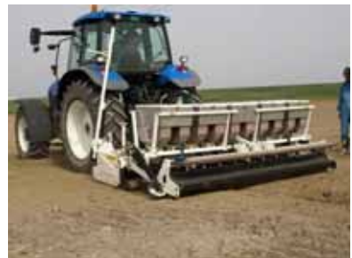
パーチカルハローシーダーによる直播作業
